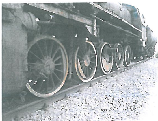
Ty2-1226 Zdekompletowany układ napędowy z lewej strony
