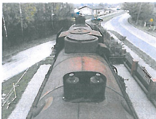
Górna część otuliny kotła, widoczne dwa zawory bezpieczeństwa, osłona zbieralnika pary, piasecznica
