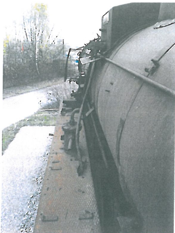
Ty2-1226 Chłodnica była umieszczona na lewym pomoście
