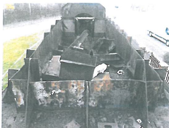
Widok od tyłu na skrzynię węglową, odcięte blachy skrzyni
