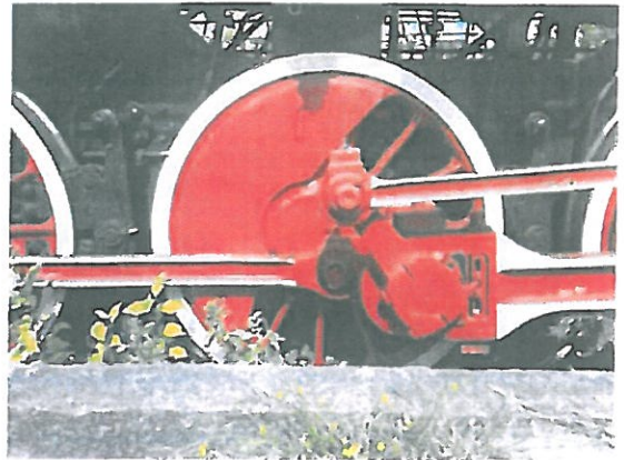
Ty42-120 Oś napędowa z prawej strony
